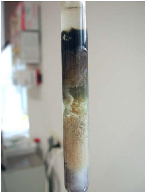
Abb. 4.5.1: Verfärbungen und Kavernenbildung bei einer mit Haldensickerwasser betriebenen Biocersäule mit Kohlenstoff-Vorfilter.
