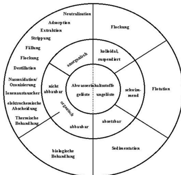
Abb. 2.1.4: Übersicht gängiger Abwasserreinigungsverfahren nach Art der jeweiligen Abwasserinhaltsstoffe.
