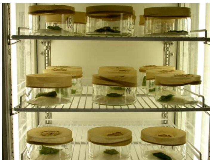
Abb. 18: Versuchsgefäßaufstellung in der Umwelttestkammer MLR-350 HT, Fa. SANYO.
