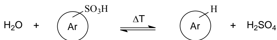
Abb. 4.1: Reversibilität der Aromatensulfonierung
