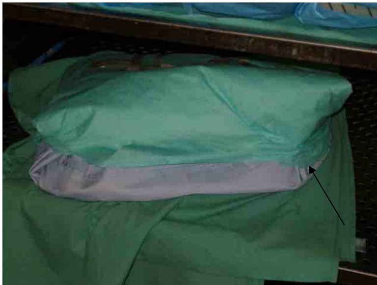
Abbildung 5-7: Großflächig perforierte Sterilverpackung nach der Sterilisation
