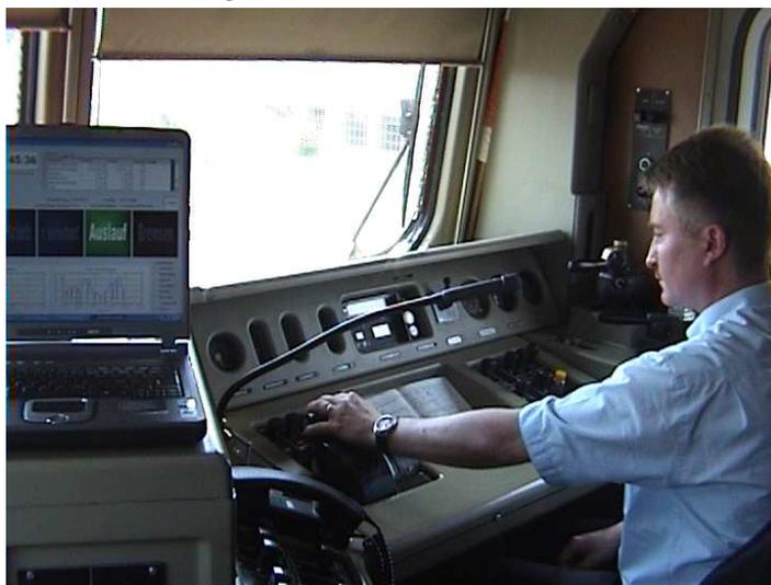
Abbildung 1.2: Das entwickelte Fahrerassistenzsystem: Der Bordrechner ermittelt aus gespeicherten und über GSM-R übermittelten Daten das jeweils optimale Fahrregime. Es kommen dabei nur die Anweisungen Antrieb mit voller Leistung, Beharrungsfahrt an der Geschwindigkeitsgrenze, Auslauf und Bremsen mit maximaler Bremsverzögerung in Betracht, die dem Triebfahrzeugführer optisch und akustisch signalisiert werden.
