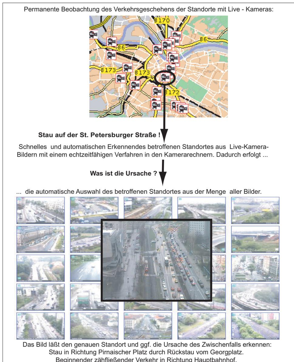
Abbildung 1.11: Ein Beispiel für die automatische Störfallerkennung (das sogenannte „incident detection“ vgl. Strobel [88]) durch Auswertung der Live-Kamera-Bilder.
