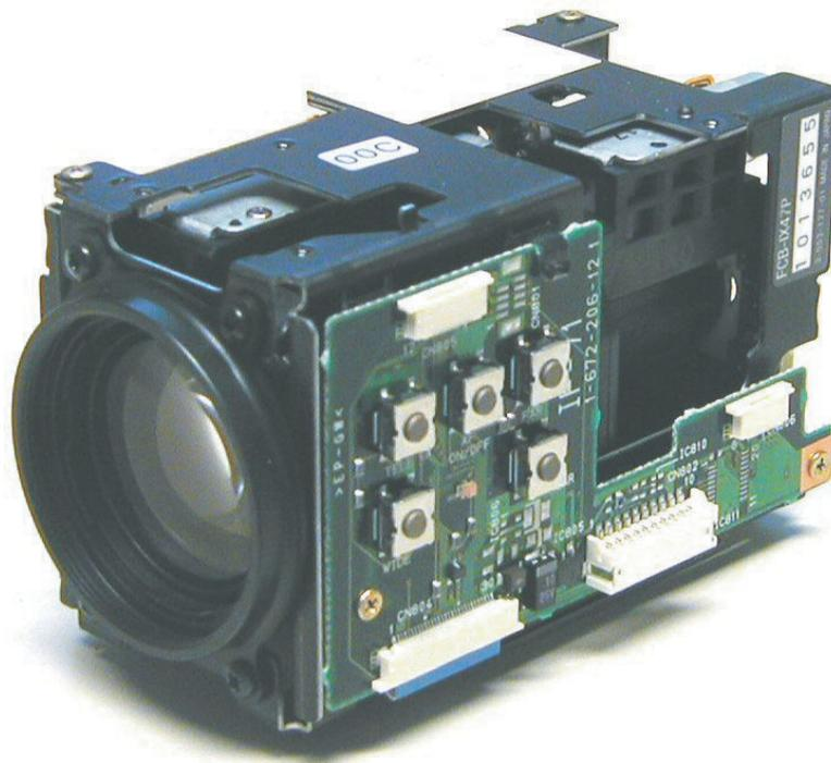
Abbildung 2.2: Beispiel für ein digitales Bildaufnahmesystem: Die in dieser Arbeit verwendete Farb-CCD-Kamera vom Typ Sony FCB-IX47.
