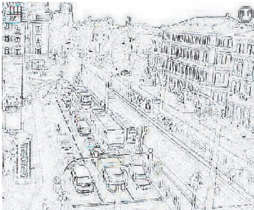
Abbildung 2.6: Kantenfilterung eines Live-Kamera-Bildes der Antonstraße in Dresden: Anwendungsbarriere durch Kantenanbedeckung.
