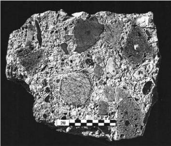
**Bild 1** Probe eines Opus Caementitium mit natürlichen Leichtzuschlägen, aus Lamprecht (2002)
