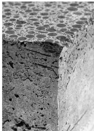
**Bild 60** Mangelnde Qualität der PK-Oberfläche durch ungeeignetes Schalöl, Beton B 1/II-1
