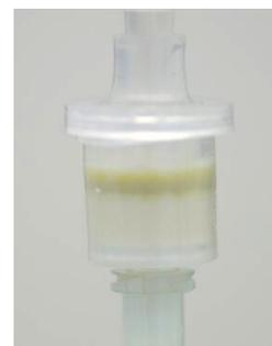
Abb. 3.44: Akkumulierung von Phenolen auf der SPE-Kartusche
