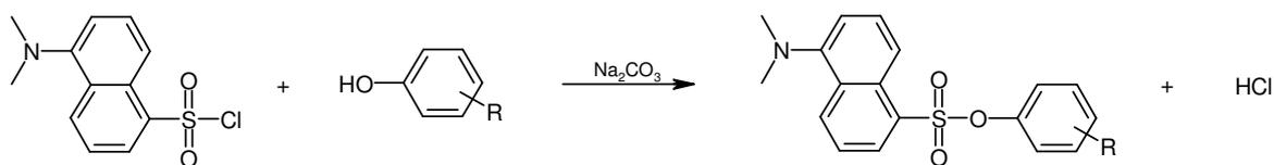
Abb. 3.16: Derivatisierung phenolischer Hydroxylgruppen mit Dansylchlorid
