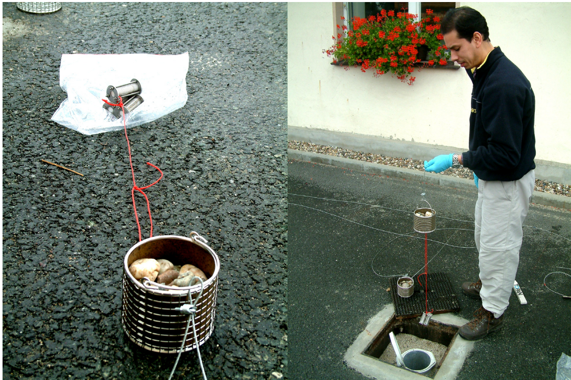
Abbildung 27: Installation der Passivsammlersysteme (PSE in zwei Messtiefen & Keramikdosimeter, dreifach) in Unterflur-Grundwassermessstellengruppen (linkes Bild: Vordergrund: PSE; Hintergrund: Keramikdosimeter; rechtes Bild: Einfahren der Sammler)
