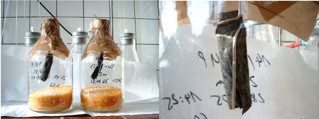
Abbildung 28: Trocknung der Adsorberpapierstreifen über Silicagel
