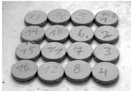
Bild 6.11 Haftzugprobekörper zur Prüfung ohne Altbetonuntergrund
