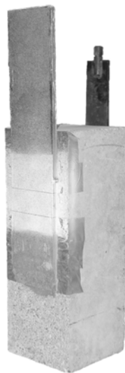
Bild 7.2 Probekörper für die Verbundversuche
