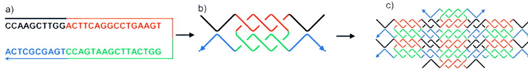
Abbildung 21: Schematische Darstellung der Assemblierung eines Netzwerkes aus gleichen Oligonukleotiden. (a) Die DNA-Sequenz eines Oligonukleotides enthält vier palindromische Abschnitte. (b) Komplex aus zwei Oligonukleotiden. (c) Diese Komplexe können zu Netzwerken assemblieren. Abb. aus [58].
