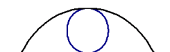
Abbildung 43: Schematische Darstellung von Abbildungsfehlern im AFM: Verbreiterung des blau dargestellten Objektes durch die Spitze. Die schwarze Kurve zeigt die abgebildete Kurve.
