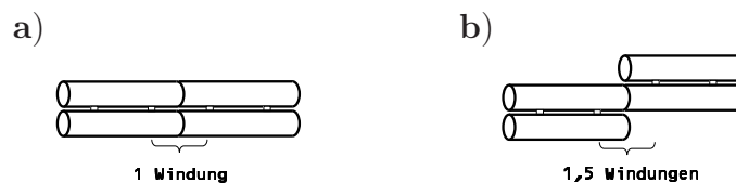
Abbildung 34: In Abhängigkeit der DNA-Länge zwischen den Strangaustauschpunkten findet eine unterschiedliche Zusammenlagerung zwischen den DX-Elementen statt. Das Schema gilt auch für alle Zusammenlagerungen, wenn derselbe Einzelstrang in den Strangaustauschpunkten ausgetauscht wird. Wenn der andere Einzelstrang ausgetauscht wird, verschiebt sich der Abstand um eine halbe Windung. (a) Die Zusammenlagerung von Bausteinen mit einem Abstand von einer Windung zwischen den Strangaustauschpunkten führt zu einem eindimensionalen Netzwerk. (b) Die Zusammenlagerung von Bausteinen mit einem Abstand von eineinhalb Windungen zwischen den Strangaustauschpunkten führt zu einem zweidimensionalen Netzwerk.
