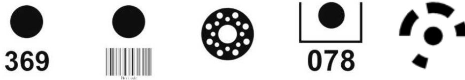
Abbildung 4.9: Auswahl von Messmarkenbeschriftungen und -codierungen [20, 24]
