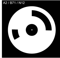
Abbildung 4.10: Modifikation von Messmarken durch einen zusätzlichen Einmesspunkt im Markenzentrum für eine optimale Einmessung im Objektraum
