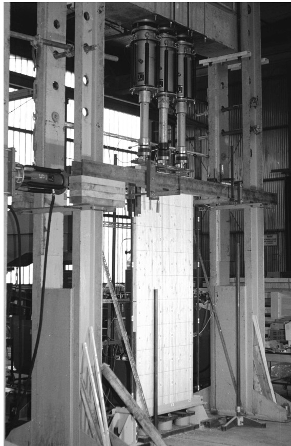
Abbildung 5.5: Versuchsstand für Brettstapelelemente
