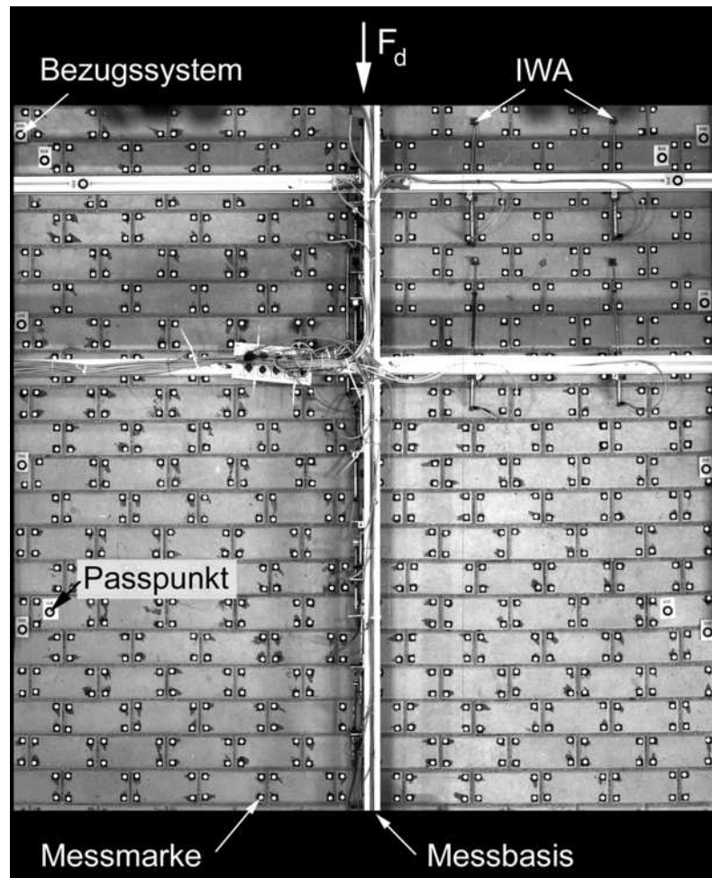
Abbildung 5.2: Photogrammetrischer Messbereich bei Untersuchungen zum Verhalten von Pflasterdecken unter horizontaler Belastung
