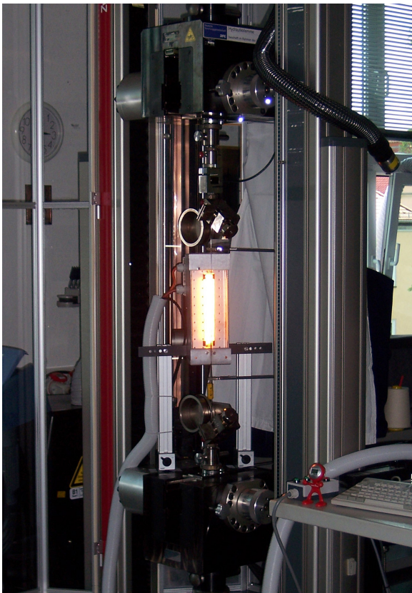
Bild 5: Versuchsaufbau zur Durchführung der Temperatur-Dehnversuche
