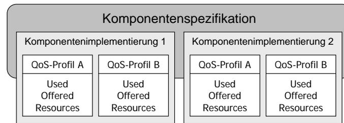
Abbildung 5.9: Beziehung zwischen Komponentenspezifikation, Implementierungen und QoS-Profilen
