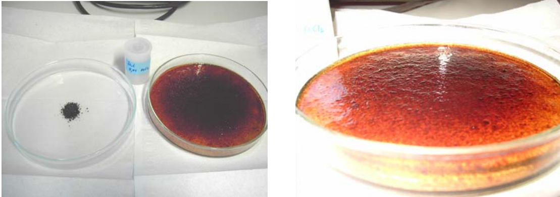
Abb. 4.48: Hydrogele der Variante IND ox-III-PEGG=Indulin oxidiert mit \text{H}_2\text{O}_2/\text{FeCl}_2 \cdot 4\text{H}_2\text{O} und vernetzt mit Poly-(ethylenglykol)-diglycidylether. Links der Vergleich zwischen Xerogel in Granulatform und gequollenem Hydrogel. Rechts vollständig gequollenes Gel
