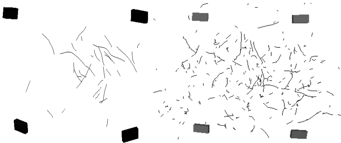
Abbildung 6.8: Trajektorien der heliumgefüllten Seifenblasen in der Ilmenauer Testzelle (links) und im Ilmenauer Fass (rechts)
