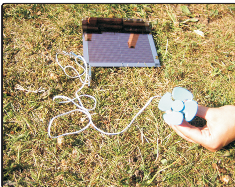
Abbildung 7.1: Eine Organische Solarzelle, basierend auf dem Oligothiophenderivat DCV5T-Bu und dem Fulleren C_{60} , treibt einen Ventilator an (Das ITO-Substrat wurde vom Fraunhofer-IPMS zur Verfügung gestellt. Die Abscheidung der organischen Schichten erfolgte durch Mitarbeiter der Firma Novaled AG).
