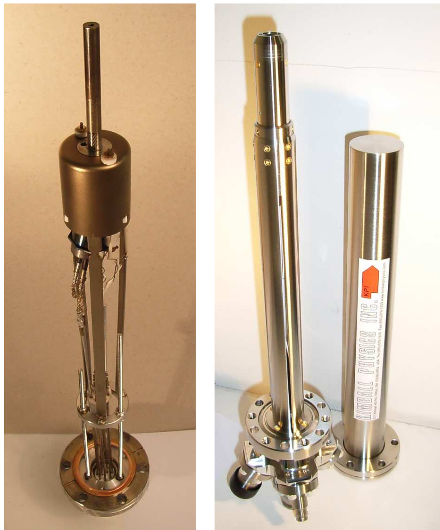
Abb. 4.6: Elektronenquellen: links) eines Varian-LEED-Systems auf modifizierter Halterung, rechts) Modell ELG-2 der Firma Kimball (abgebildet mit Transporthülle). Da die Probenposition in der Kammer durch die Anordnung der Linsen für die optische Spektroskopie vorgegeben ist, müssen die Elektronenkanonen sehr lang sein, um durch den Bodenflansch der Vakuumkammer ausreichend nah an die Proben heranzureichen. Nur so kann der optimale Arbeitsabstand von < 50 mm realisiert werden.
