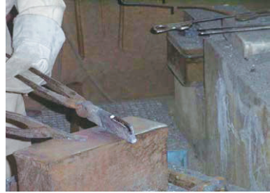
写真3-18 刃金が継ぎ合わされる
