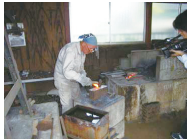
写真3-20 継ぎ合わせたものを熱して鍛える
