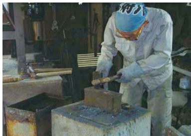
写真3-1 刃金部分への打ち込み 刃金用の部材を 必要なサイズにカットする工程
