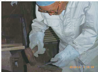
写真3-46 茎の先端を曲げる
