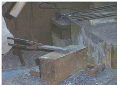
写真3-11 刃金を挟み込む
