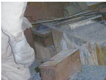
写真3-9 刃金と地金を熱する
