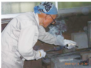
写真3-48 柄に差し込み 差込は、 茎に合わせて穴を調整
