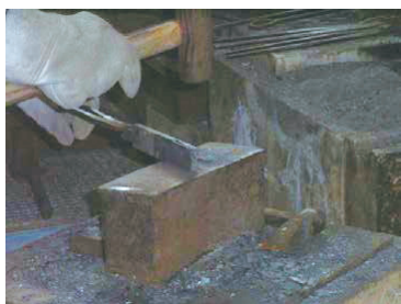
写真3-13 挟み込んだ部分の鍛造
