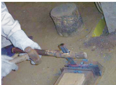
写真3-5 熱しては割り込む
