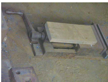
写真3-8 地金を締める道具
