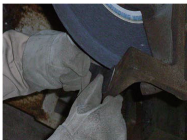
写真3-43 先端(引っかけ部分)の砥ぎ
