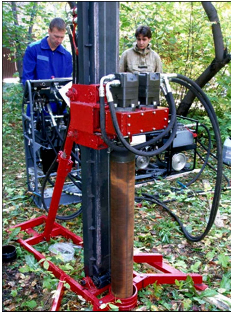
Рис. 13. Малогабаритная буровая установка МГБУ-400 «Термит».
