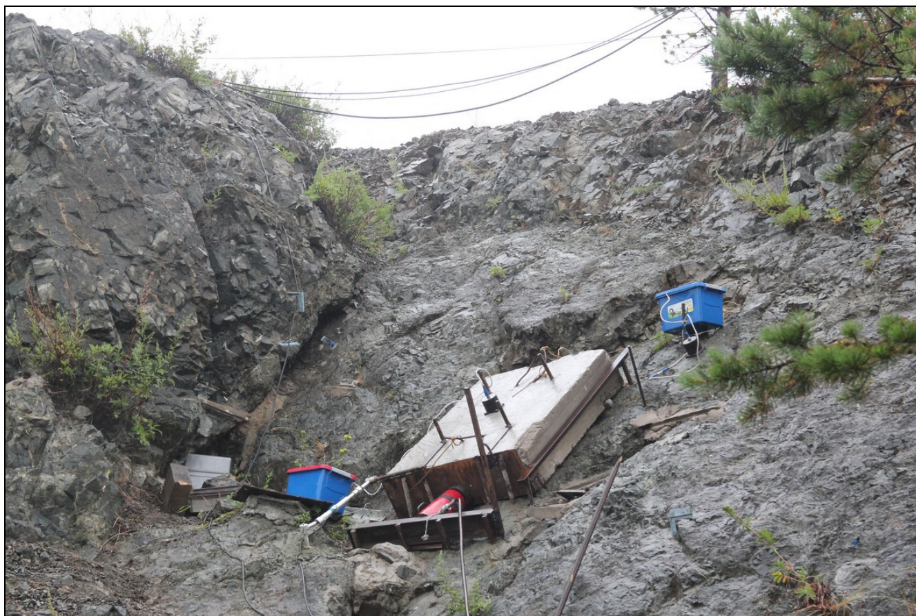
Рис. 2. Устройство испытательного стенда «Трибо», размещенное на фрагменте плоскости Ангарского разлома. Видна плита с датчиками сейсмостанций, домкратом, датчиками силы и линейных перемещений.
