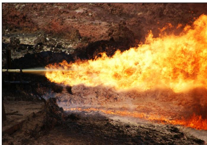
**Рис. 11.** Отработка скважины с ГС – 1000 м на факельный амбар после бурения (с кольматацией). Очистка скважины. Юрубченская залежь. Внизу видна горящая дорожка кольматанта [Vakhromeev et al., 2014].
