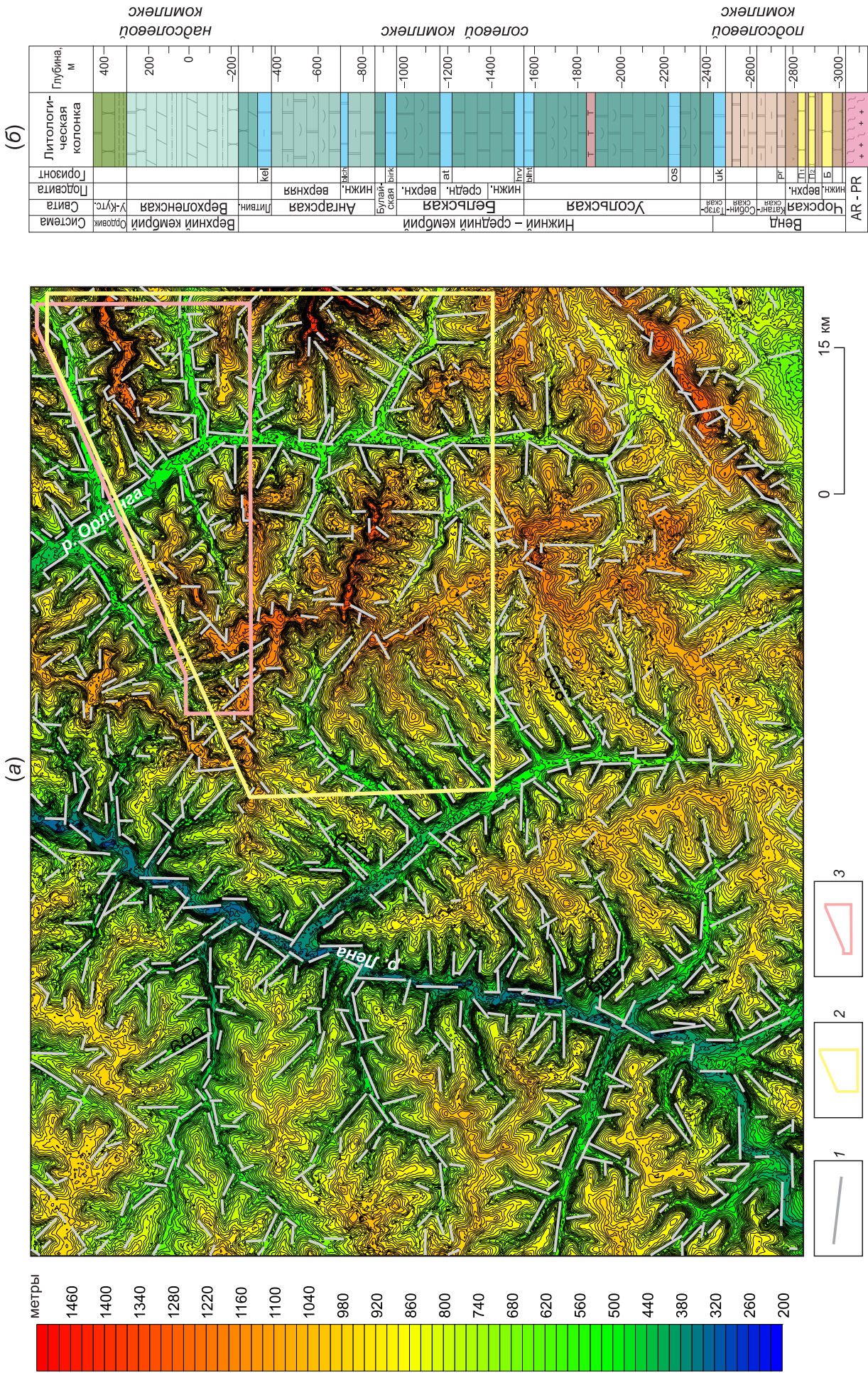
Рис. 3. Карта рельефа в изолиниях (а) и стратиграфическая колонка осадочных комплексов (б) для Ковыктинского ЛУ. 1 – линсаменты рельефа; 2-3 – участки детальных сейсморазведочных (2) и электроразведочных (3) работ.
