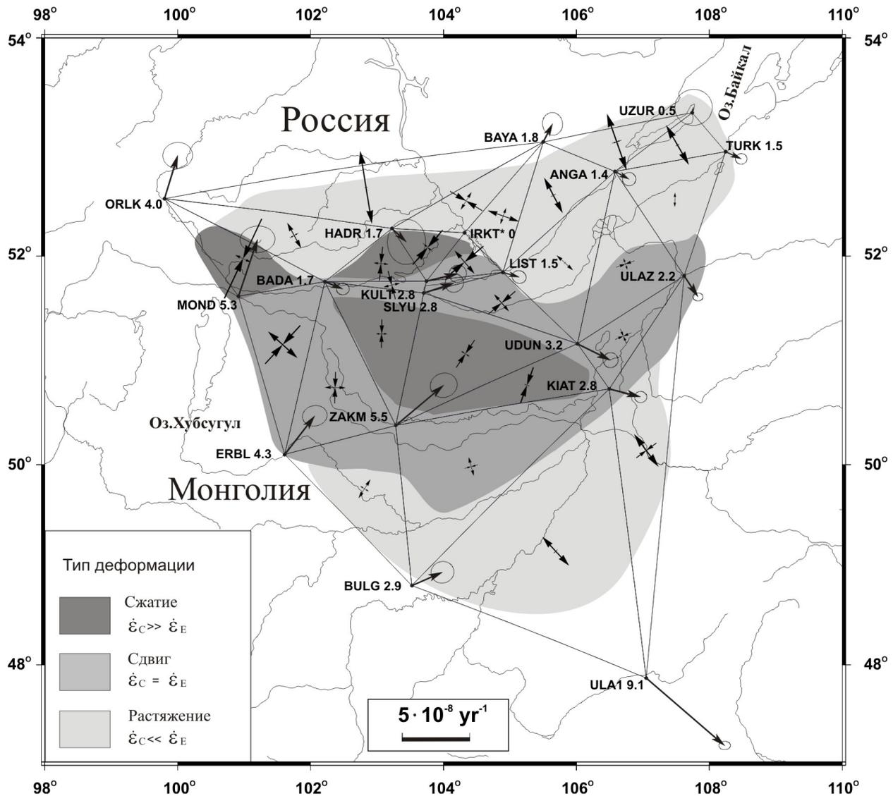
**Рис. 8.** Поле скоростей современных горизонтальных движений и деформаций южного обрамления Сибирской платформы по данным измерений на Байкальском и Монгольском GPS-полигонах за 1994–2001 гг. Векторы скорости смещений пунктов относительно ИРКТ показаны с эллипсами 95%-ного доверительного интервала. Рядом с пунктами наблюдений указаны аббревиатуры их названий и значения скорости движений в мм/год [Лухнев и др., 2003].
