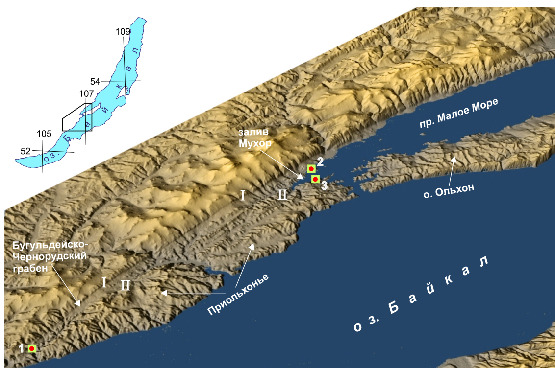
Рис. 2. Обзорная схема расположения разломов и участков проведения электротомографических исследований в Приольхонье (Западное Прибайкалье). Цифры на схеме: I – Приморский сброс; II – Тырган-Кучелгинский сброс; 1–3 – площади исследований (1 – Бугульдейская, 2 – Улирбинская, 3 – Онтхойская).
