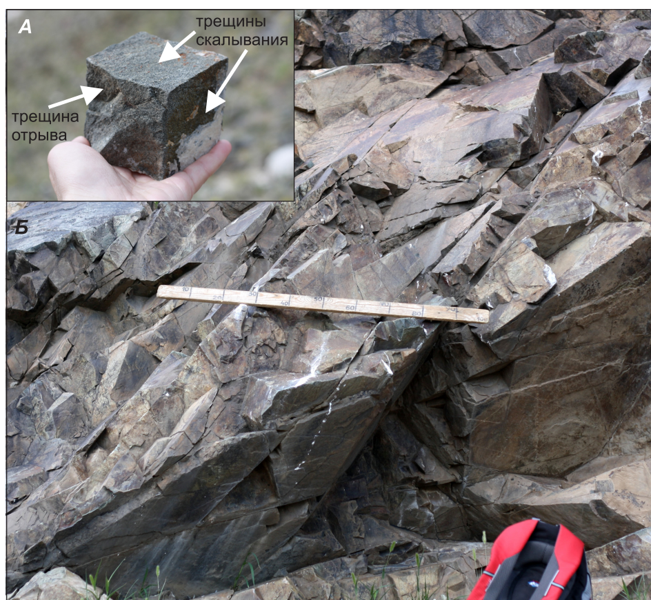
Рис. 6. Трещины скальвания и отрыва в горных породах.
