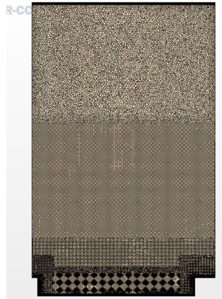
b) Streamwise midplane mesh (LES)
