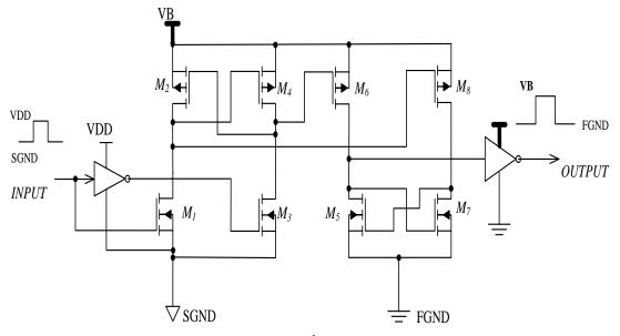
Figure 4.7 2<sup>nd</sup> level shifter
