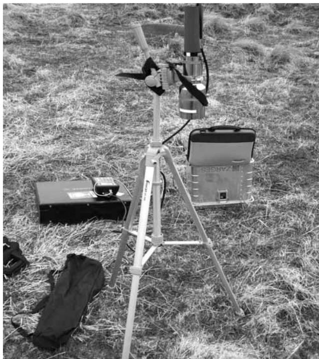
**Рис. 1.** Определение энергетического спектра гамма-фона с помощью полевого сцинтилляционного гамма-спектрометра «DigIDART»
