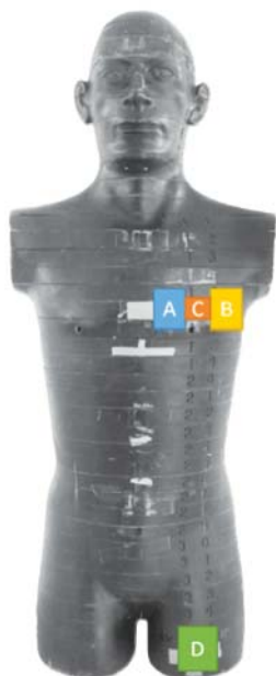
Рис. 5. Расположение ТЛД- и ОСЛД-дозиметров на поверхности фантома: А – ТЛД-дозиметр для определения индивидуальной дозы; В – такой же ТЛД-дозиметр, как и А, но с поваренной солью; С – новая версия ОСЛД-дозиметра с солью; D – упаковка обычной поваренной соли. Фантом показан без пластиковой пленки
