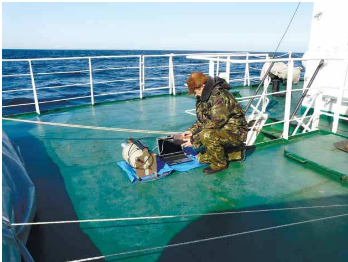
Рис. 15. Определение спектрального состава фона гамма-излучения на палубе НИС «Павел Гордиенко» (корма судна) с помощью полупроводникового гамма-спектрометра фирмы ОРТЕС. Спектрометр расположен в над местом крепления ФВУ, использованной для отбора проб аэрозолей воздуха (см. рис. 10). Измерения проводит В. Рамзаев
