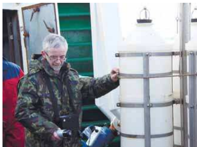
Рис. 8. Измерение мощности дозы гамма-излучения на палубе НИС «Павел Гордиенко» с помощью дозиметра-радиометра МКС-АТ1117М. Измерения выполняет Г. Брук (датчик прибора находится в правой руке исследователя)
