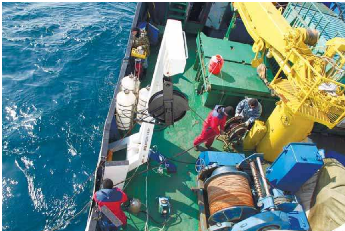
Рис. 11. Выполнение работ по отбору проб воды с глубины 50 м на борту НИС «Павел Гордиенко». Показан момент монтажа установки «Спрут» – крепление погружаемого шланга к тросу лебедки. Работы проводят А. Никитин, Е. Вехов, Г. Артемьев и А. Севастьянов. Фото И. Ермаченкова
