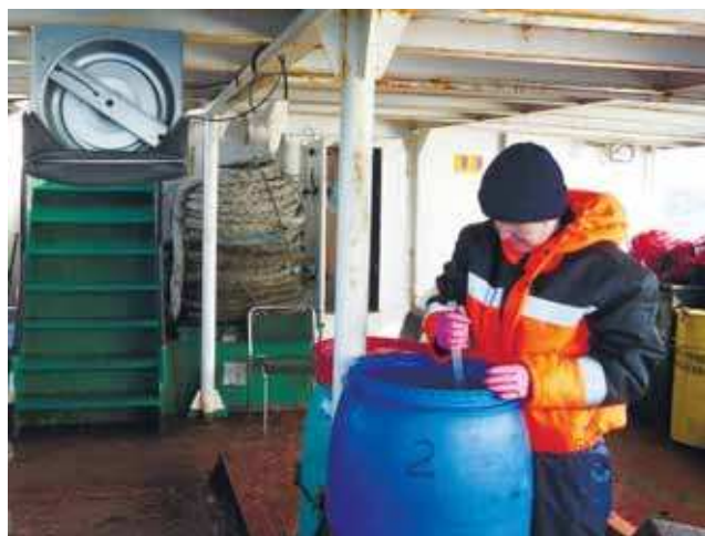
Рис. 13. Радиохимический анализ. Рабочий момент предварительного концентрирования изотопов плутония из пробы морской воды на борту НИС «Павел Гордиенко». Работы выполняет А. Федорова
