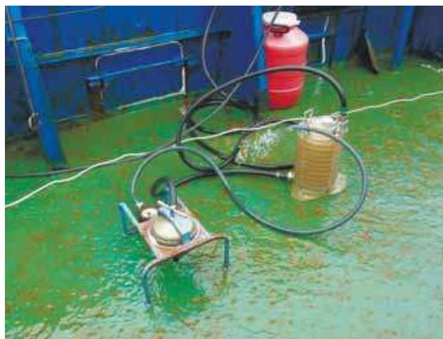
Рис. 12. Фильтрующая установка «Мидия» (справа) и абсорбер на борту НИС «Павел Гордиенко» во время работ в 87-м рейсе
