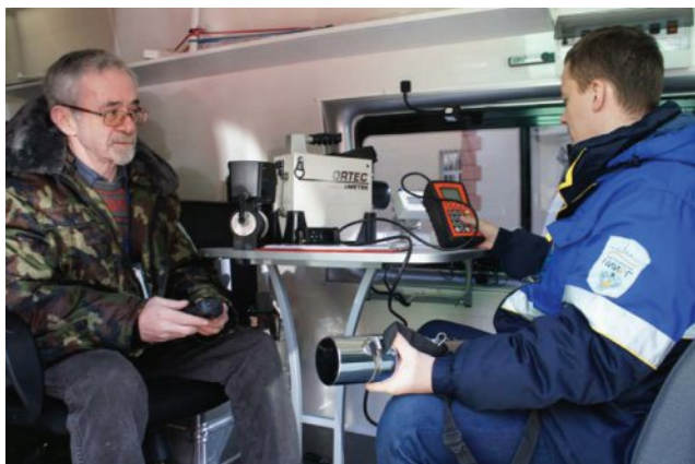
Рис. 3. Специалисты радиологической группы Института радиационной гигиены готовятся к проведению измерений спектра гамма-излучения
