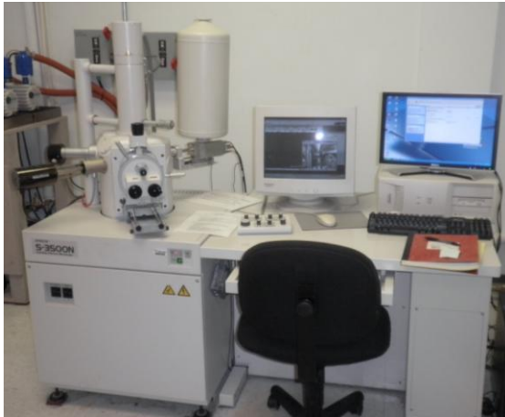
Figure 28. Hitachi S-3500N SEM
