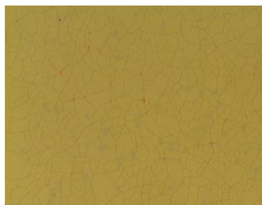
(d) Heavy cracking
