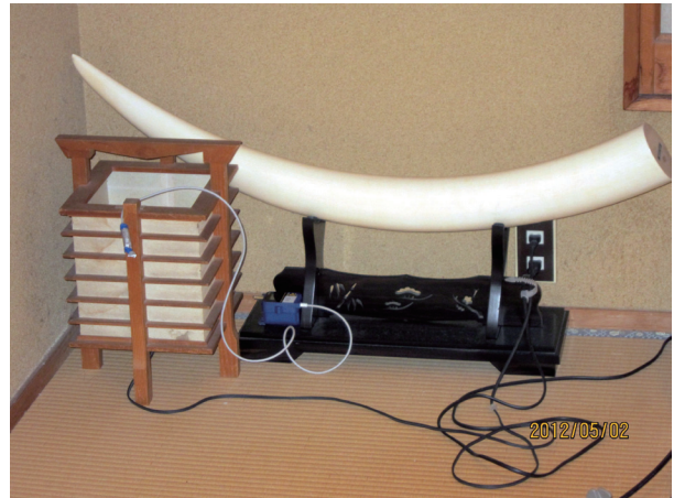
写真2-7 床置き照明器の箇所温湿度センサーを設置。
