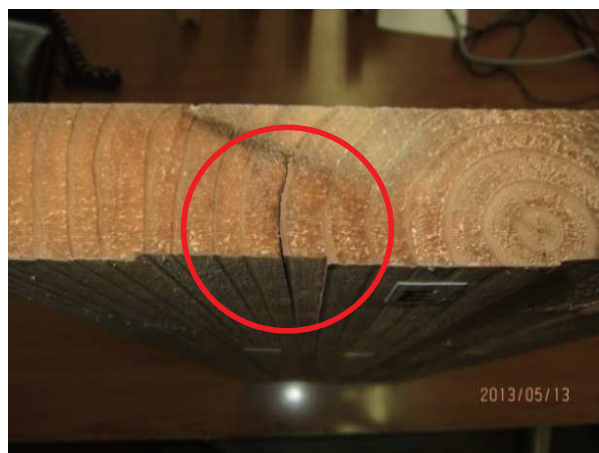
実験開始時(上) ひび割れ発生時(下) 写真11 試験体E
