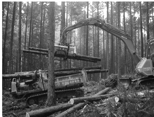
図3-7 積込搬出（林内車による山土場への搬出）
