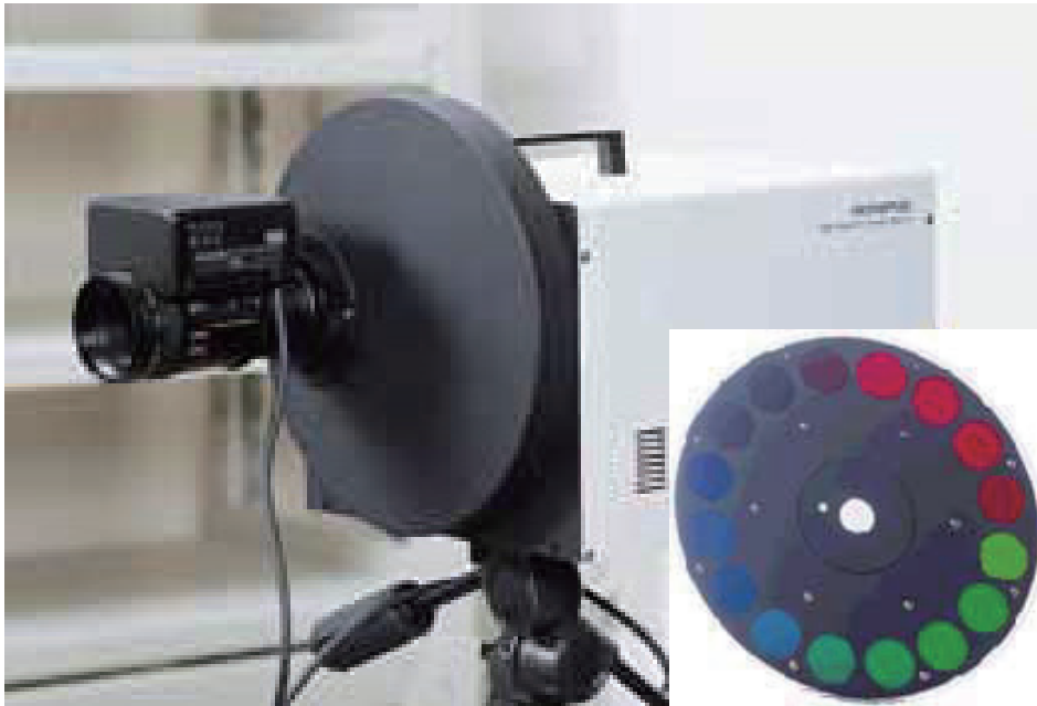
図 2.6 干渉フィルタを用いたマルチバンド画像撮影装置 [49]
