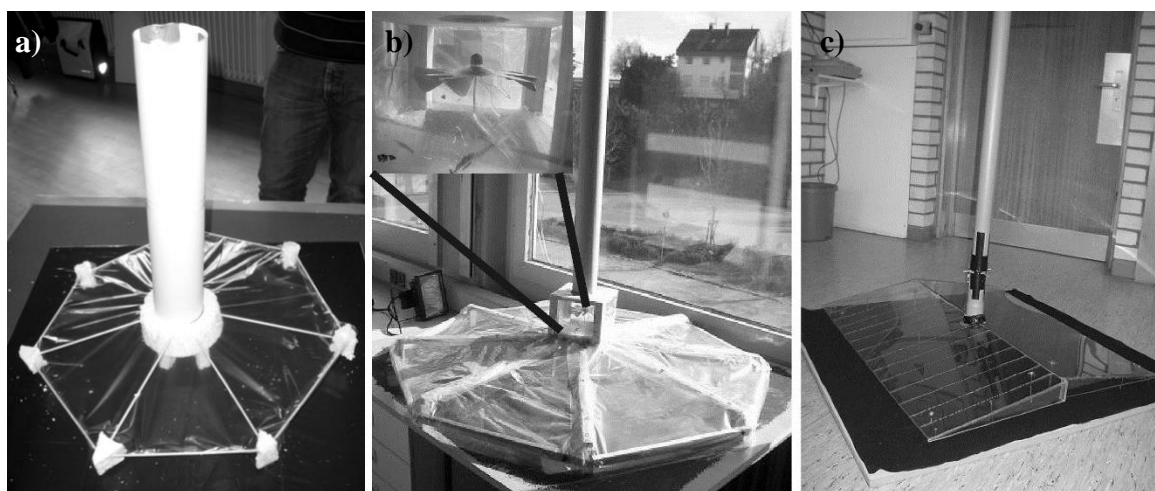
Abbildung 1: Aufwindkraftwerkmodelle von Schülerinnen und Schülern; a) Low-Cost-Modell aus Papier und Folie, b+c) Verarbeitung von Holz, Metall und Plexiglas in den Modellen bei freier Materialwahl
