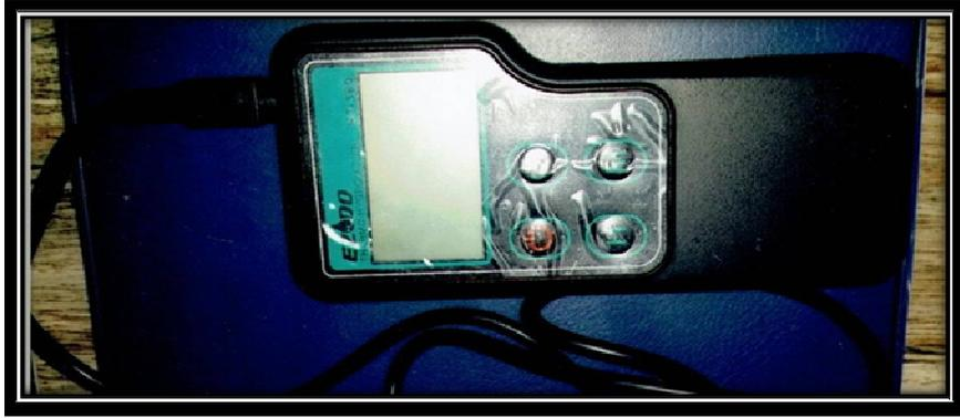
صورة (١) جهاز قياس درجة الحرارة والرطوبة النسبية HT – 380 Thermo – Hygrometer
