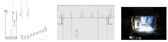
شكل (5) يوضح واجهه ومقطع في مسرح CRAFTON-PREYER في جامعه كنساس. يوضح الشكل واجهه إطار الفتحة وموقع أجهزة الاسقاط الضوئي على جانبي إطار الفتحة لتقديم عروض الواقع الافتراضي والوسائط المتعددة. ويوضح المقطع تدرج الأرضية نسبه (1:3)، وارتفاع الخشبة عن الأرضية (60سم). فضلا عن وجود أجهزة الاسقاط الضوئي على جانبي فتحه المنصة.
