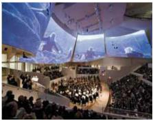
شكل (8): يوضح الشكل الأشرعة الصوتية والاستعراضية التي تعمل كشاشات عرض فضلا عن وظيفتها الصوتية. [22]
