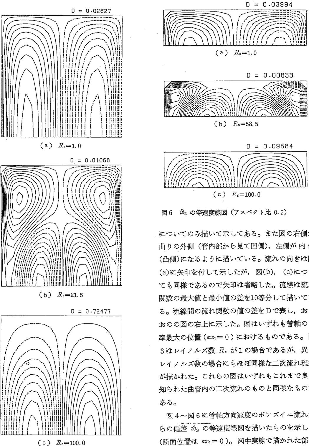
図5  $\hat{w}_2$  の等速度線図 (アスペクト比2)
