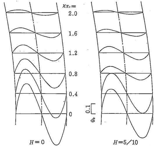
図8 管軸方向各断面の  $w_2$  分布 ( $R_e = 1$ )
