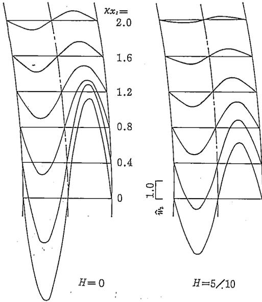
図10 管軸方向各断面の  $w_2$  分布 ( $R_e=100$ )
