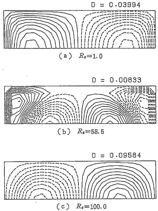
図6  $\hat{w}_2$  の等速度線図 (アスペクト比0.5)
