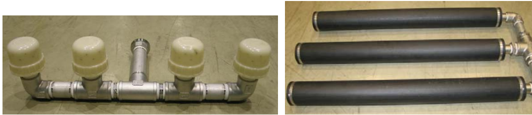
図 1-2 粗大気泡散気装置(左)および微細気泡散気装置(右)の例(photo by Terashima)
