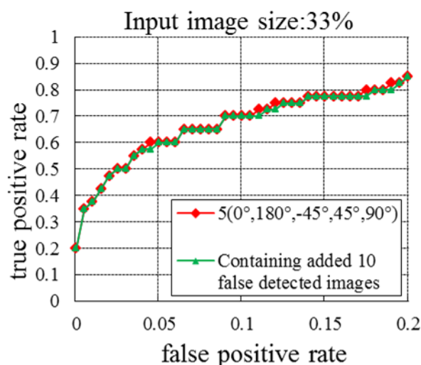
図3. 29: 10枚のランダムな誤検出画像を含んだ入力画像の照合結果 (ROCカーブ)
