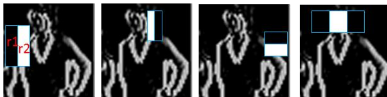
図2.5: ソベル画像にHaar-likeフィルタを適用する例
