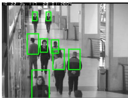
図2.1: 上半身の人物検出アルゴリズム適用結果（データは[26]のデータベースから抜粋）
