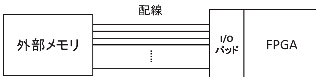
図 3.16: 外部メモリ-FPGA 間の I/O パッド, 配線
