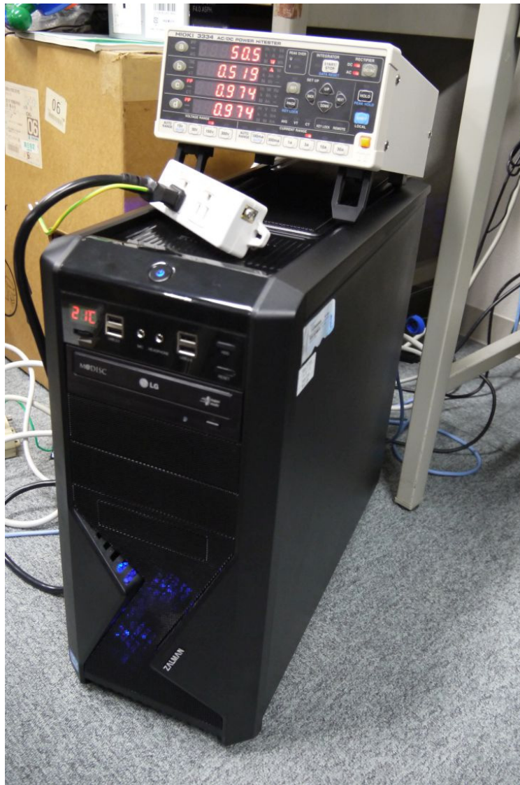
図 3.16 消費電力の計測に用いる電力計 (HIOKI AC/DC パワーハイテスタ 3334)
