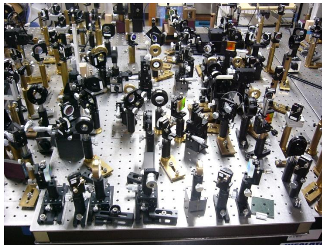
図 3.22: 狭帯域 OPA と 0 分散フィルター。図 3.19 の配置を上側から撮影しており、手前に 0 分散フィルターがある。
