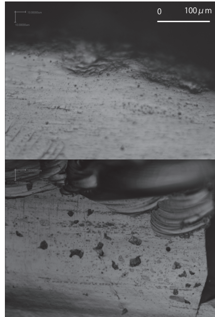
図3 No.K73 木・黒檀 切断 潤滑 8分 500倍で撮影 (saw, ebony-wood, wet, 8 minutes)
