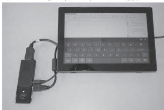
(図5) スティック型コンピューターとタッチパネル式モニターとの接続
