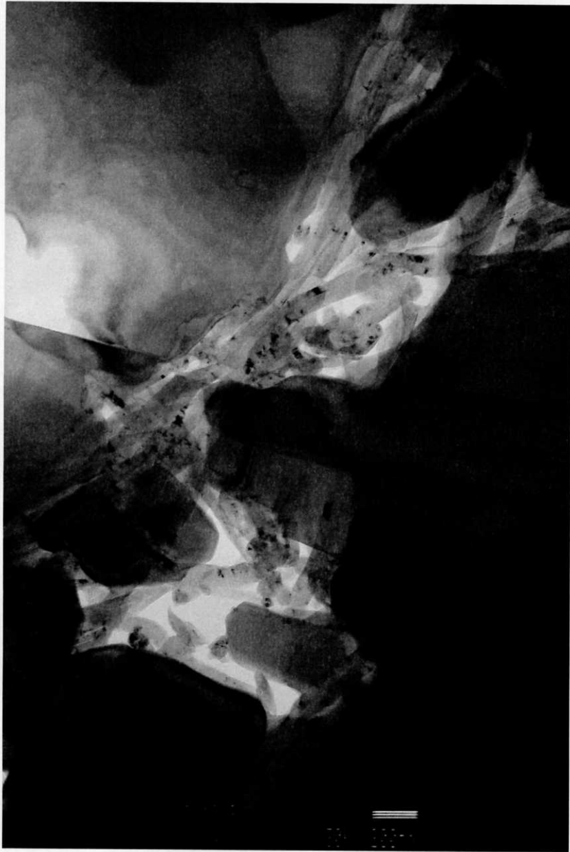
図 28 肉厚多層カーボンナノチューブアルミナ複合材料の透過電子顕微鏡写真
