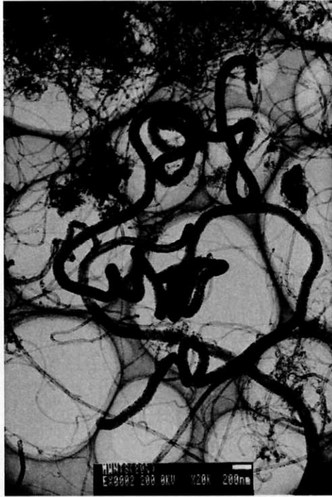
図 18 ナノラボ社製の肉薄多層カーボンナノチューブの TEM 像
