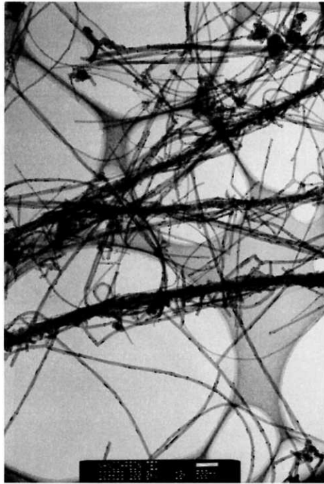
図 20 ナノカーボンテクノロジーズ社の肉厚多層カーボン ナノチューブの TEM 像
