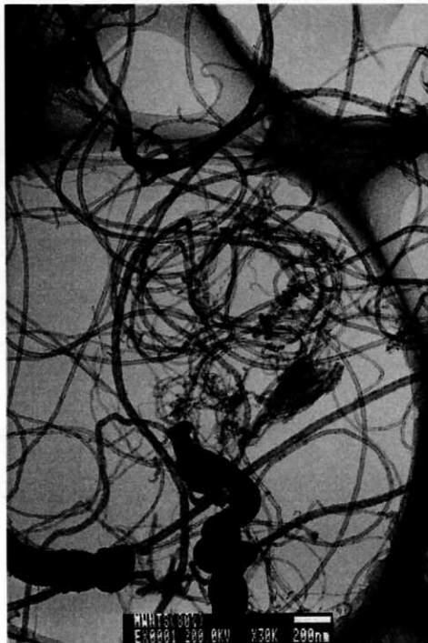
図 19 ナノラボ社の肉薄多層カーボンナノチューブの TEM 像
